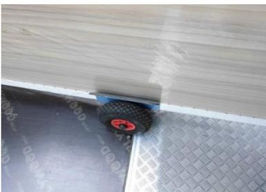
Arbeitsplattenroller (z.B. für schwere Arbeitsplatten)
